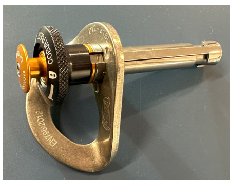
3. Återanvändningsbar bult och fästögla
